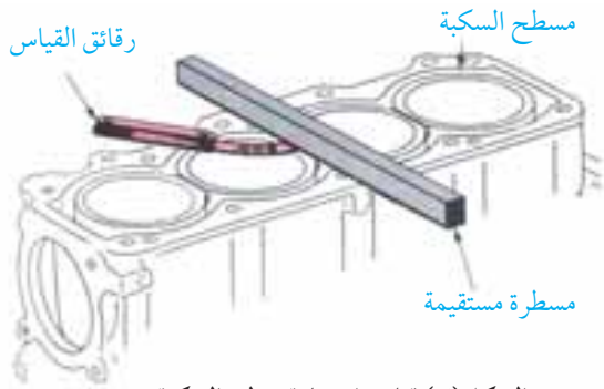
الشكل (٧) قياس إستقامة سطح السكة
